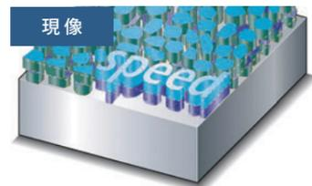
現像液により露光部が2層とも溶解され、未露光部は溶解されずに画線部となります。
